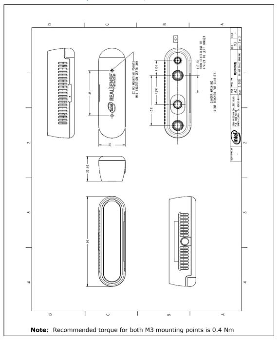
Figure 10-9. Intel<sup>®</sup> RealSense<sup>™</sup> Depth Camera D435/D435i
